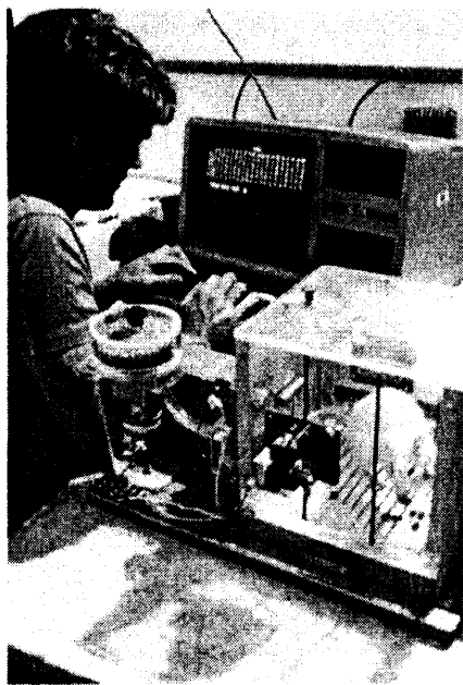
Fig. 7.8. Dispozitivul utilizat pentru studierea condiționării operante. Imaginile arată o cușcă Skinner, prevăzută cu o magazie de hrană, din care se oferă porțiile necesare desfășurării experimentului. Computerul este folosit pentru a controla experimentul și a înregistra răspunsurile șobolanului.
